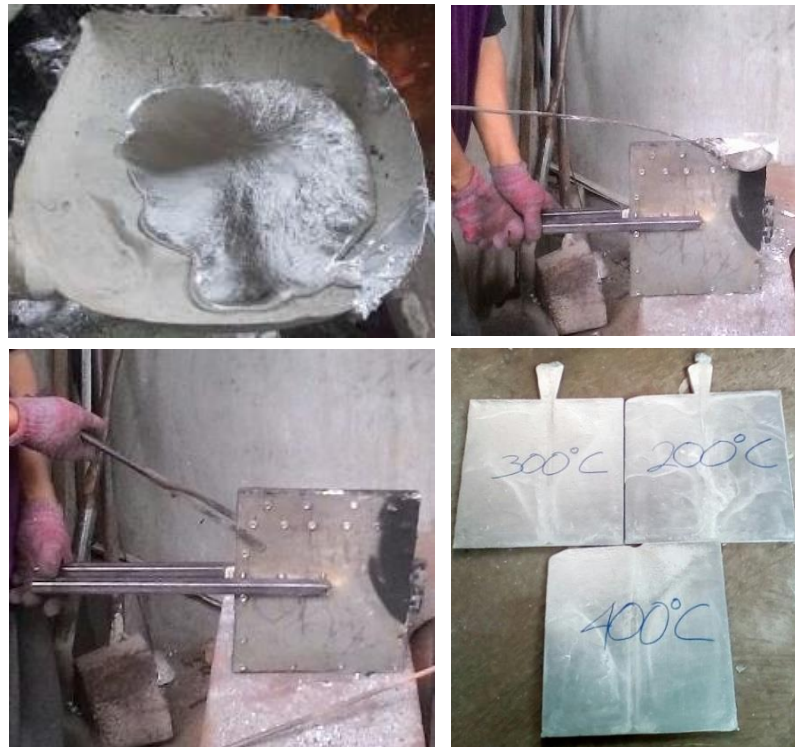
Gambar 4.3 Proses penuangan logam cair kedalam cetakan
