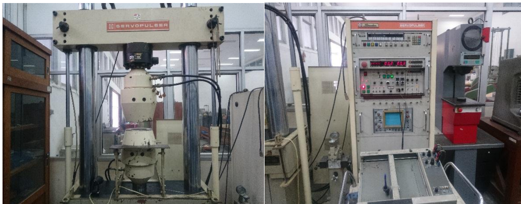
Gambar 3.21. Mesin Uji Tarik Servopulser ( Laboratorium Bahan Teknik UGM )
