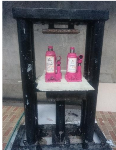
Gambar 3.9 Alat pengepres cetakan
