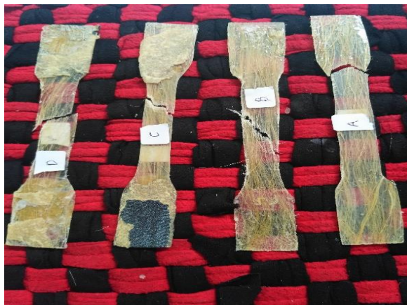
Gambar 4.5 Patahan pengujian tarik
