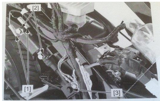
Gambar 3.16 Pemeriksaan Kabel Body.(PT. Astra Honda Motor : 2014)
