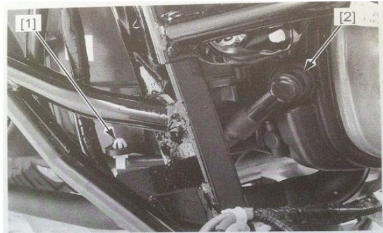
Gambar 3.15 Pemeriksaan Klem Kabel Busi.(PT. Astra Honda Motor : 2014)
