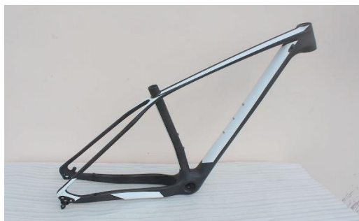
Gambar 2.1Rangka sepeda gunung (sumber : https://Aliexpress.com )
