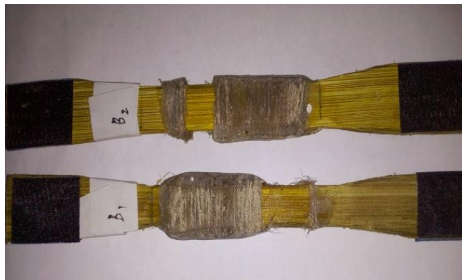
Gambar 4.6 Sambungan Strap Ghoni Setelah Uji Tarik
