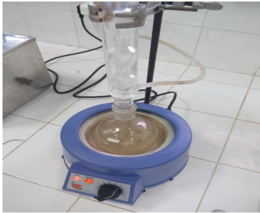
Gambar 15. Analisis penyabunan dengan pendingin balik
