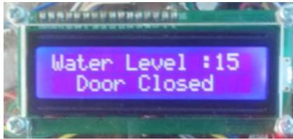
Gambar 4.4 Mode Otomatis Pada LCD
