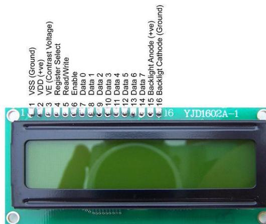
Gambar 2.8 Bentuk fisik dan Pin LCD 2x16
