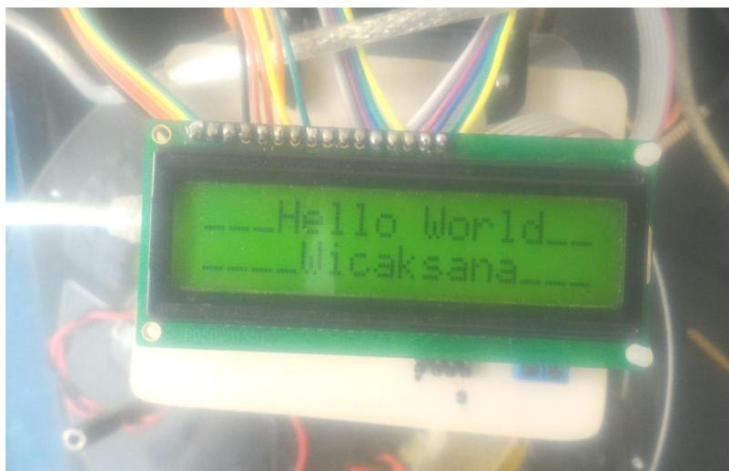
**Gambar 4.5** Uji Karakter pada Tampilan LCD 2x16.
