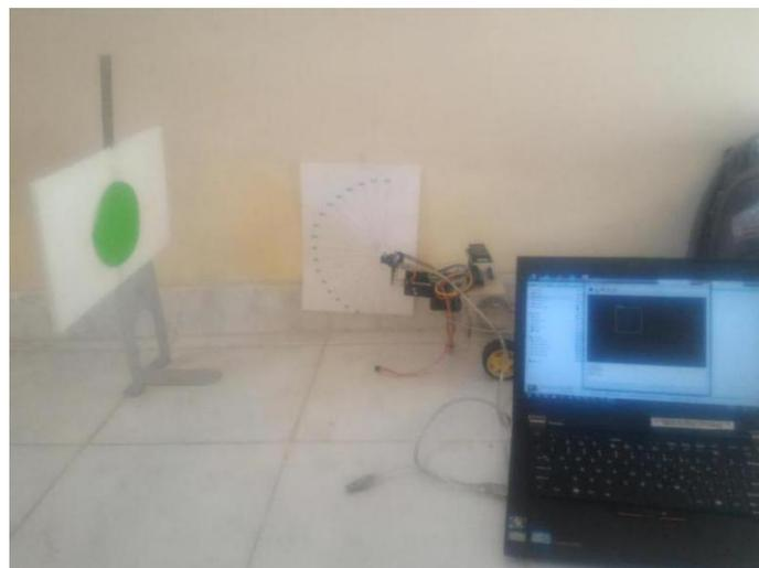
**Gambar 4.10** Uji Sudut Deteksi Kamera secara Vertikal
