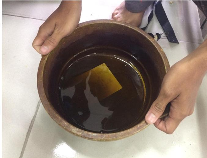
**Gambar 3.16** Proses Pelarutan *PCB* dengan  $\text{FeCl}_3$ .
