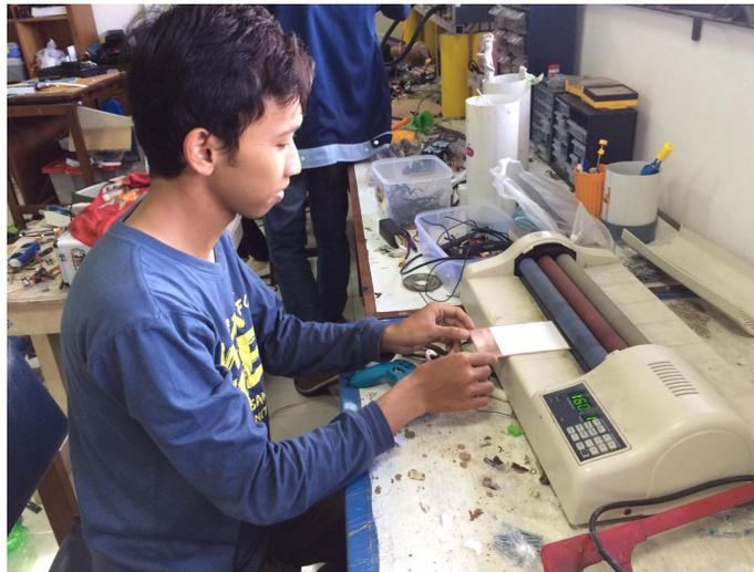
**Gambar 3.15** Proses Pemindahan Skematik Rangkaian ke *PCB* .
