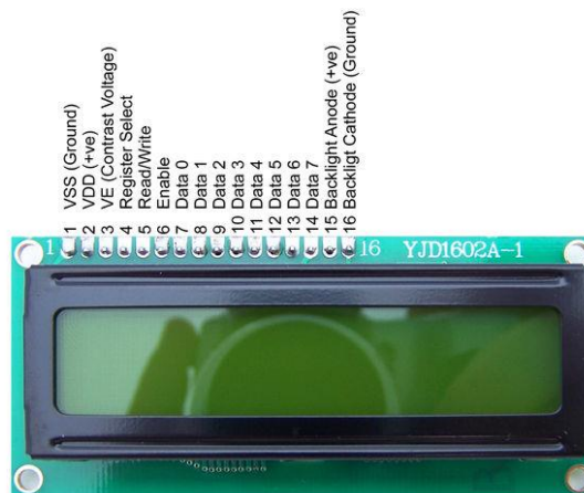
Gambar 2.2 Bentuk Fisik dan Pin LCD 2x16 [5]
