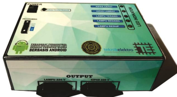
Gambar 4.1 Box tampak depan dan atas
