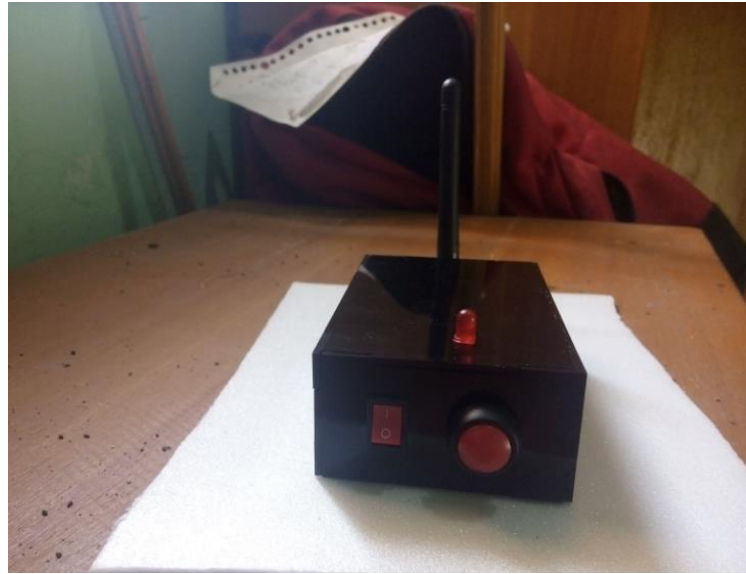
Gambar 4.1 Pengendali Darurat Tampak Depan.
