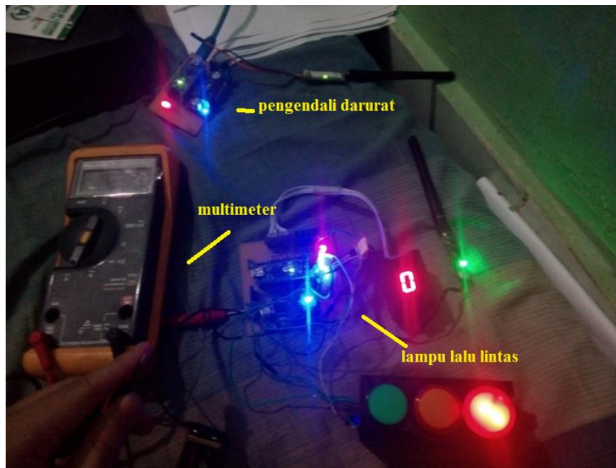
Gambar 4.9 Pengujian Arus Total Lampu Lalu Lintas Saat Pengendali Darurat Aktif.
