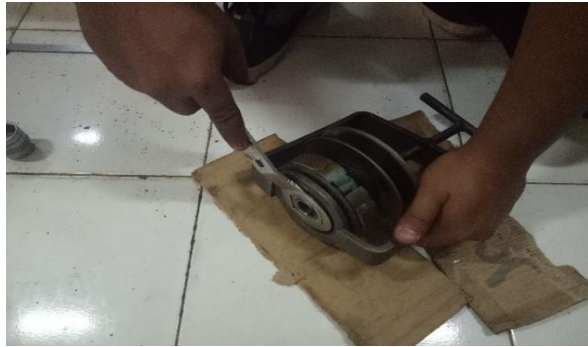
Gambar 3.23 Proses memasang sepatu kopling
