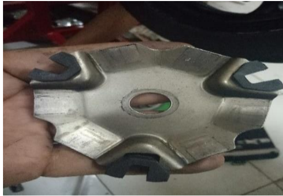
Gambar 3.25 Proses memasang slide piece
