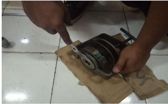
Gambar 3.10 Proses melepas sepatu kopling
