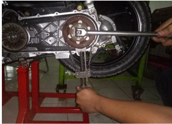
Gambar 3.29 Proses memasang outer clutch
