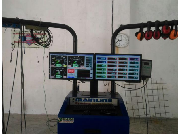
Gambar 3.2 Mesin Dyno test di bengkel 3Dara Sukses Sukoharjo
