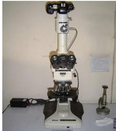
Gambar 2.13 Alat Uji Struktur Mikro
