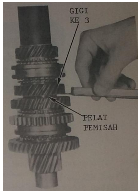
Gambar 3. 28 Mengukur kelonggaran antara plat pemisah dan ujung tepi gigi 3
