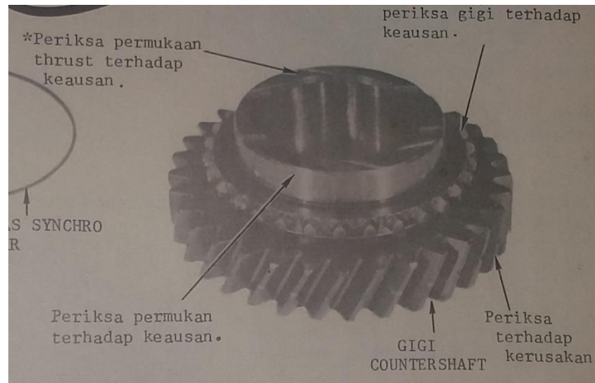
Gambar 3. 16 Pemeriksaan permukaan thrust terhadap keausan
