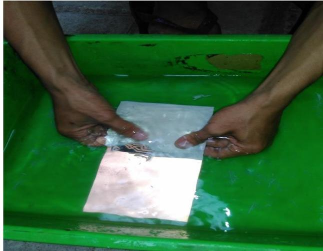
**Gambar 3. 10** Pada saat membersihkan kertas foto pada papan *PCB*
