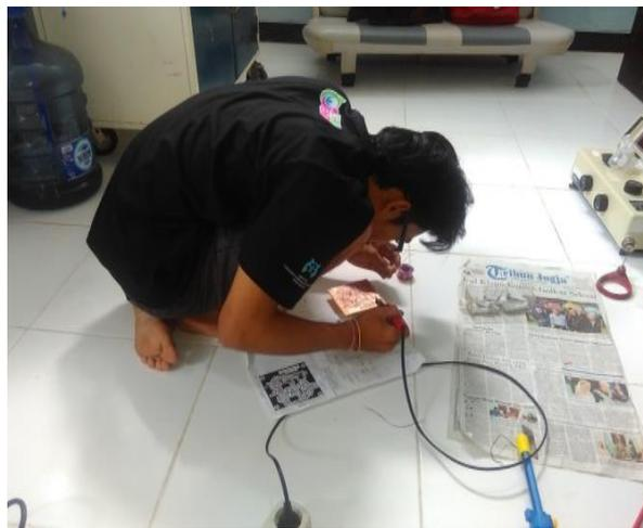
**Gambar 3. 6** Hasil foto proses penyolderan
