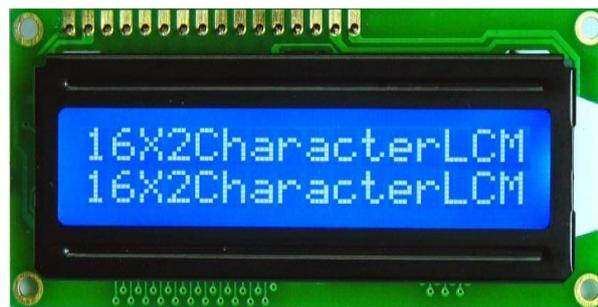
Gambar 2.3 Skematik LCD 2x16.
