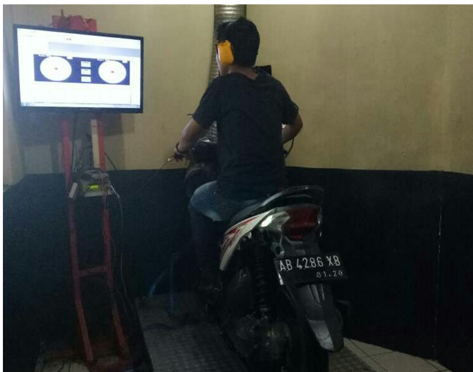
Gambar 3.12 Proses pengujian menggunakan alat Dynotest
