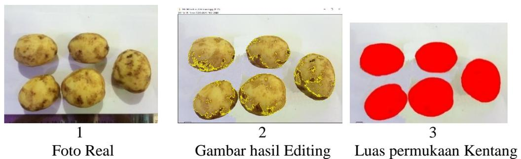
**Gambar 4.3. Hasil pengupasan dengan variasi pulley 50,8 mm : 76,2 mm.**
