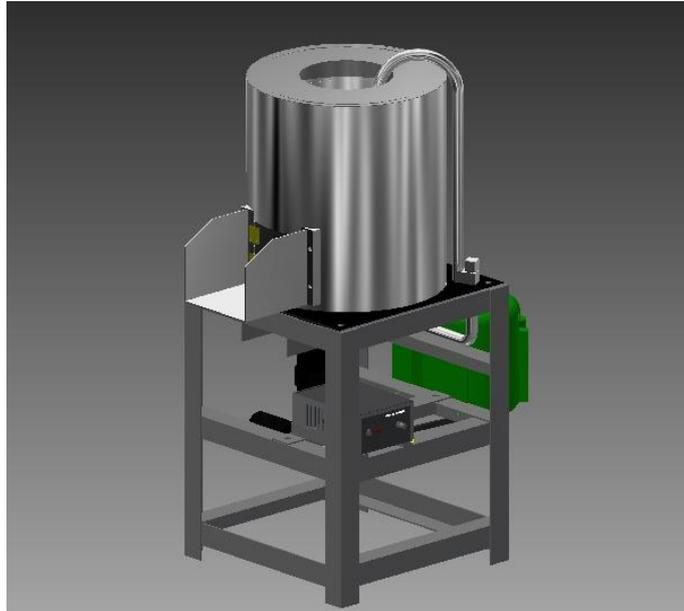
**Gambar 3.11. Mesin pengupas kulit kentang**
