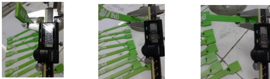
Gambar 3.12 Pengukuran lebar spesimen di 3 titik
